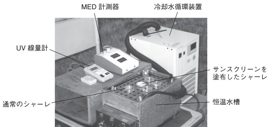
図 3 太陽光曝露装置
